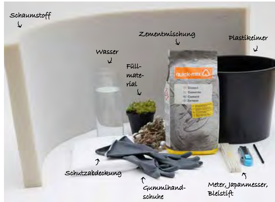
Matériaux: mousse, mélange de ciment (et eau), seau en plastique, plastique de protection, gants en caoutchouc, mètre, cutter, crayon
